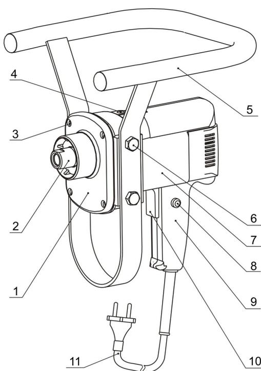
1 - редуктор; 2 - шпindelь; 3 - винт; 4 - отверстие M10; 5 - ручка в сборе; 6 - болт; 7 - электропривод; 8 - фиксатор; 9-ручка-накладка; 10 - выключатель; 11 - шнур питания.
